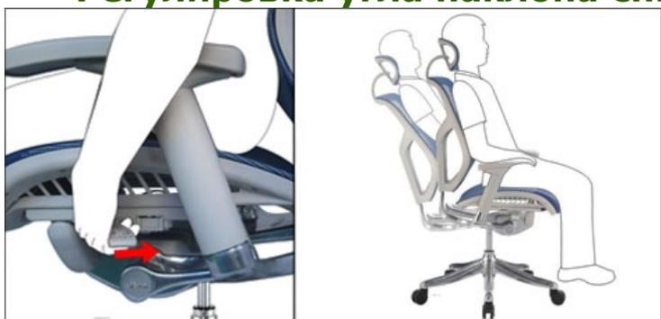
Для регулировки угла наклона спинки потяните за рычаг с правой стороны и используйте кнопку с правой стороны под сиденьем. Отклонитесь назад до удобного угла спинки, для фиксации отпустите рычаг. Когда Вы встанете, спинка вернется в вертикальное положение, когда сядете в кресло, спинка вернется к ранее установленному углу наклона. Предусмотрено 4 положения фиксации в диапазоне 28 градусов. Выбор удобного угла наклона при работе или отдыхе позволяет снять нагрузку со спины.
