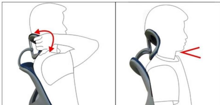
3. Возьмитесь за подголовник, чтобы отрегулировать угол наклона. Предусмотрена возможность регулировки в диапазоне 80 градусов.
