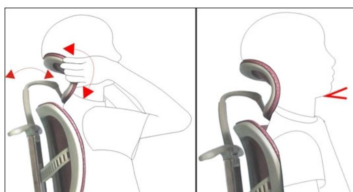
3. Возьмитесь за подголовник, чтобы отрегулировать угол наклона. Предусмотрена возможность регулировки в диапазоне 60 градусов.
